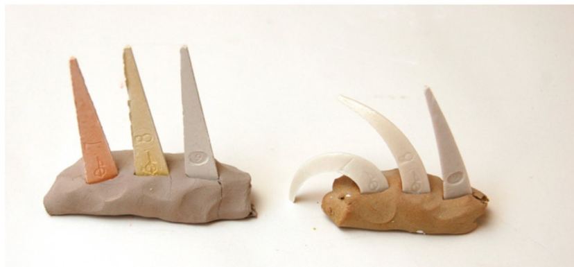
Conos pirométricos Orton antes y después de la cocción.
