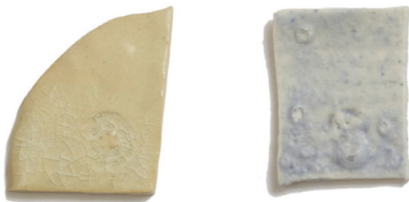
Pastillas de prueba que muestran el cuarteado en un esmalte transparente ( izquierda ) y la formación de ampollas en un esmalte mate con cenizas de hueso ( derecha ).
