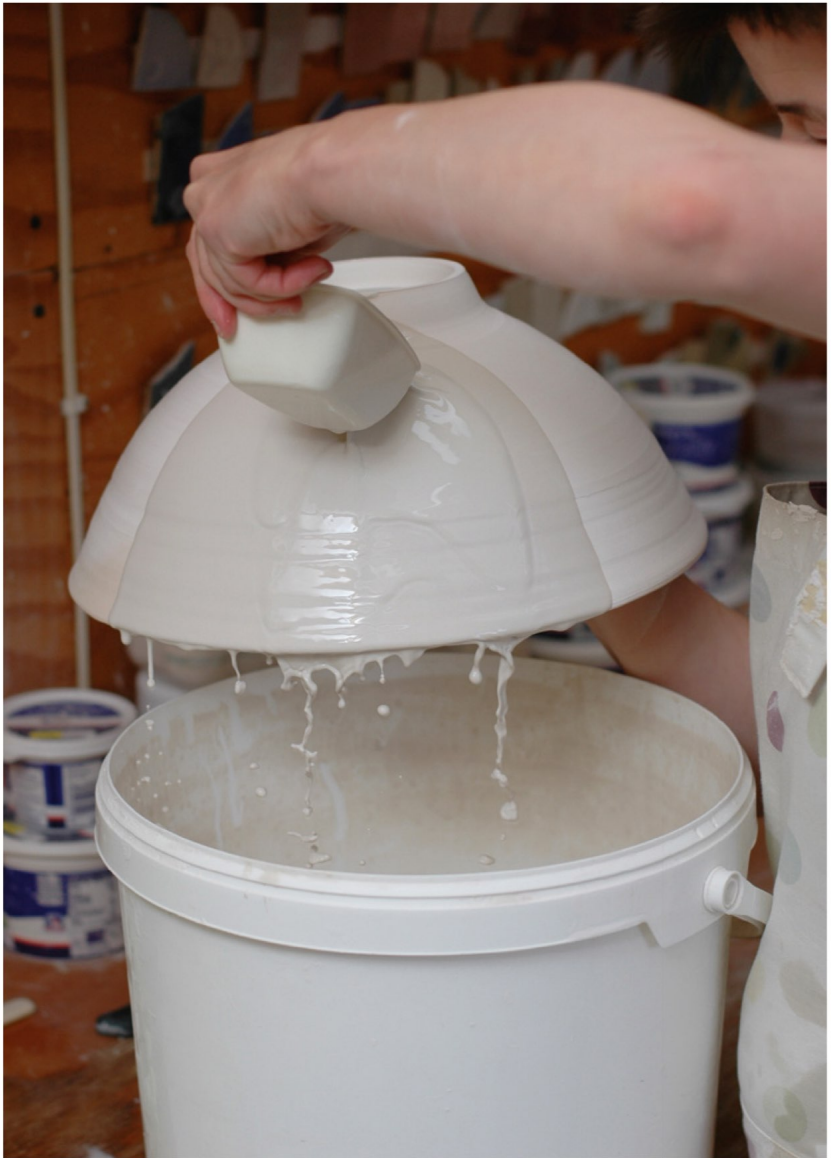
Vertiendo el esmalte sobre el exterior de un cuenco.
