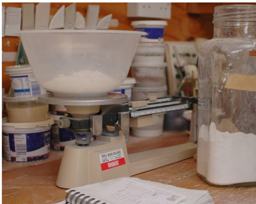
Pesando los materiales de un esmalte en una balanza de tres brazos.
