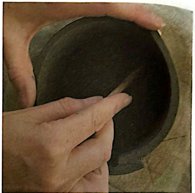
16 Alisa la unión con una herramienta de modelado y un dedo húmedo. En este punto, puedes quitar la horma para acceder al interior de la pieza y suavizar la junta también por este lado.
