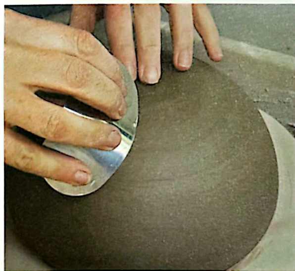
8 Por último, para suavizar la forma, pasa una media luna flexible de acero por la superficie. Así obtendrás una buena base en la que tallar.
