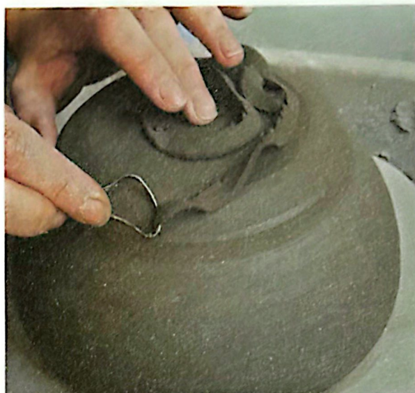
6 Cuando el cuenco tenga dureza de cuero, retira la arcilla que sobre y refina la forma. Humedece la rueda del torno para fijar el cuenco puesto boca abajo. Con la herramienta de torneado, empieza a recortar los bordes.
