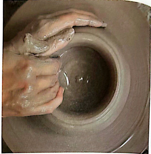
2 Haz un hoyo en el centro con los pulgares; después, abre la base. Yo le he dado a mi pieza una base bastante amplia para que puede contener cómodamente una vela grande.
