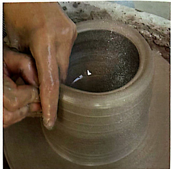
4 Empieza a levantar las paredes. Aplica más presión en la parte exterior para evitar que la pieza se acampane hacia fuera.
