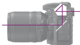
Recorrido de la luz en el interior de una cámara réflex.
