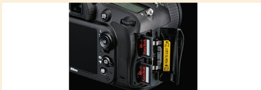
Figura 3.27. Las cámaras con doble slot nos permiten realizar una copia de respaldo mientras fotografiamos. En este caso podemos verlo en esta DSLR Nikon.
